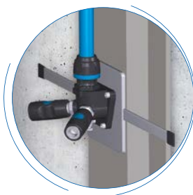
FIXATION SUR POUTRE IPN/HEA AVEC PLATINES
